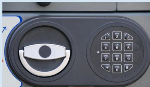
LE MECANISME DE FERMETURE EST CONSTITUE DE DEUX PENES ACTIONNES PAR UNE POIGNEE MOBILE. LE VERROUILLAGE DE L'ENSEMBLE EST ASSURE PAR UNE SERRURE A COMBINAISON ELECTRONIQUE AVEC OUVERTURE TEMPORISEE REGLABLE DE 1' A 99'.
